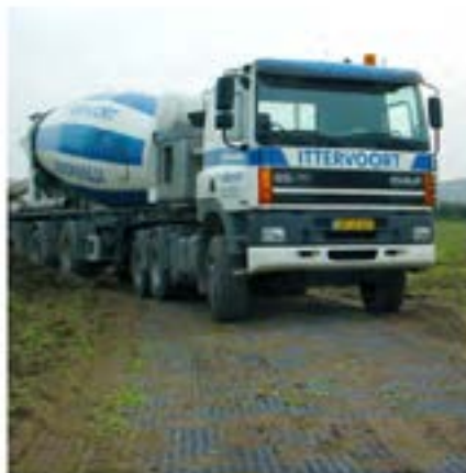
Kunststoff Rasengitter können nicht aufgesperrt verlegt werden
